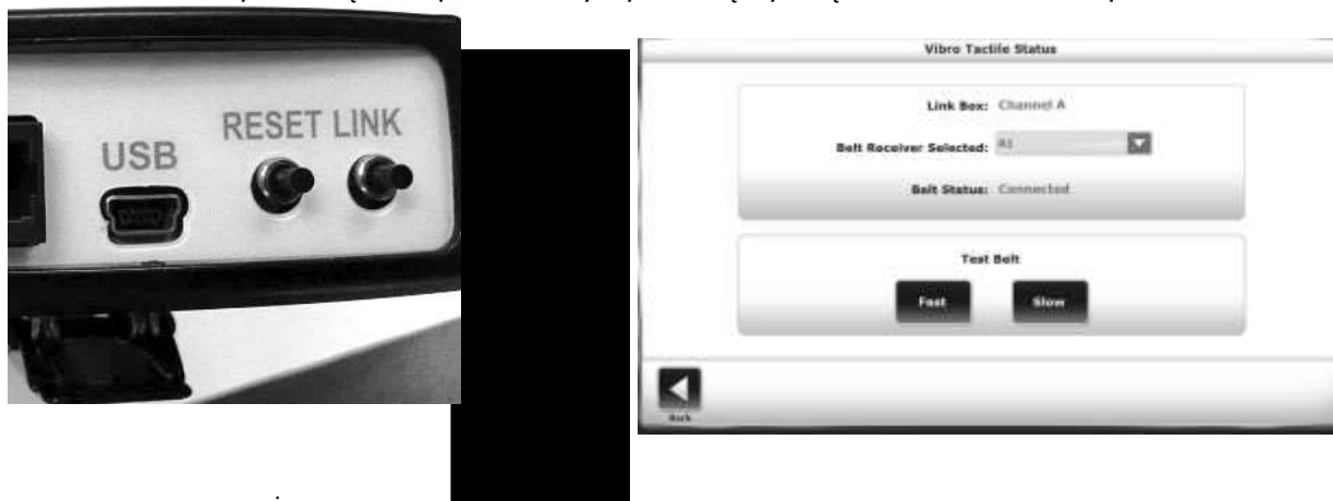
Rysunek 8.12. Dotknij LINK do połączenia bezprzewodowego. Podłącz odbiornik paska.
