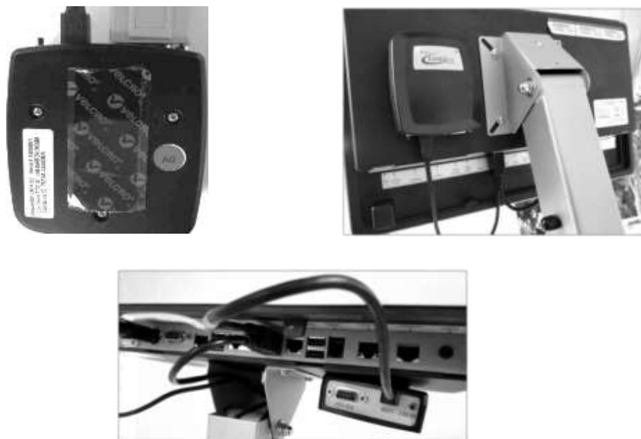
Rysunek 8.3. Instalowanie złącza z tyłu wyświetlacza
