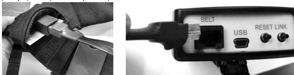
Rysunek 8.4. Podłączanie odbiornika do paska.
